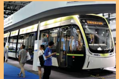
中国南车浦镇公司生产无接触网锂电储能式 100% 低地板有轨电车 CSR Puzhen: Catenary-less, Lithium Energy-Storage, 100% Low-floor Modern Tram
